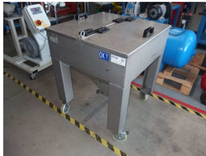
Silo diario 150 litros a pie de máquina.
