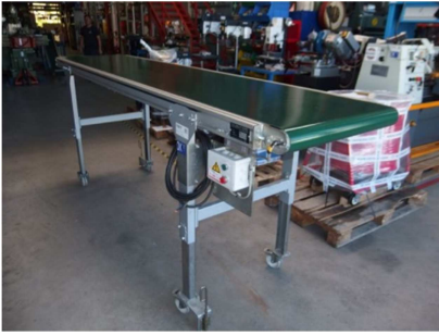
Cinta transportadora plana 3000x620 mm.
