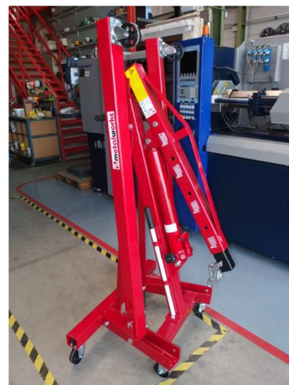
Grúa portátil 2 ton y 2300 m/m altura.
