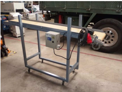
Cinta transportadora plana 2150x400 mm.
