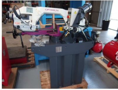
Tronzadora de Sierra Cinta arco giratorio 275 m/m
