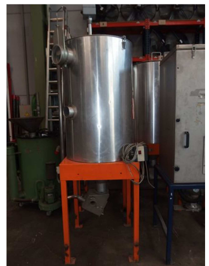
Tolva de almacenamiento 300 litros calorifugada
